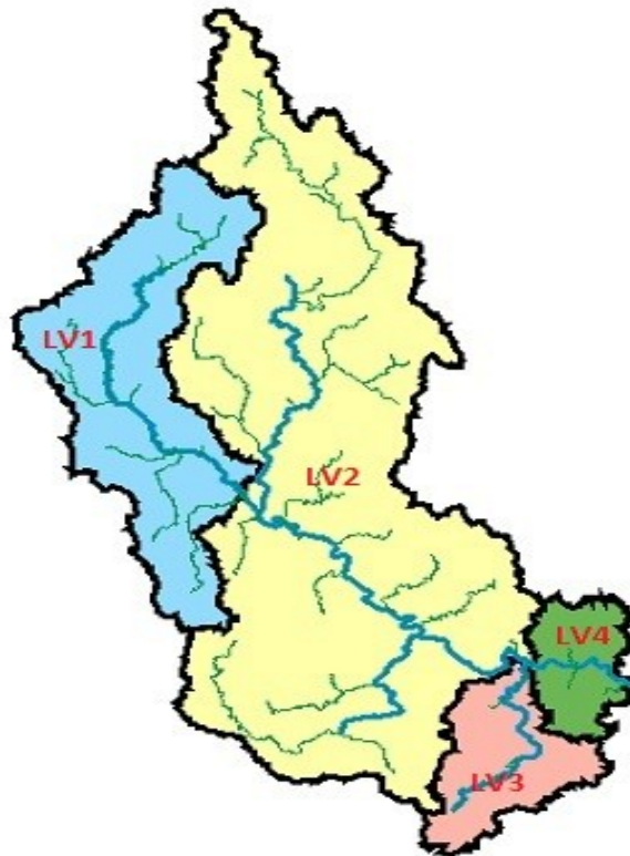
Hình 1. Sơ đồ phân chia lưu vực sông Ba sử dụng trong mô hình MARINE.
