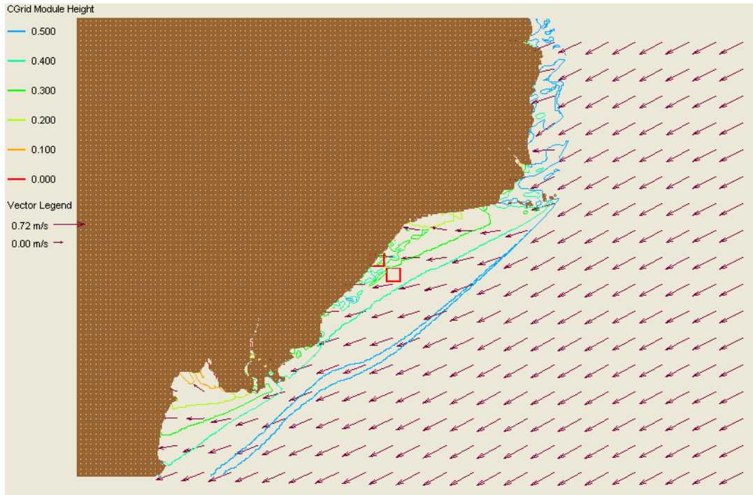
Hình 5. Bản đồ trường sóng vùng ven bờ tính toán theo mô hình STWAVE – 10 h ngày 4/1/2003
