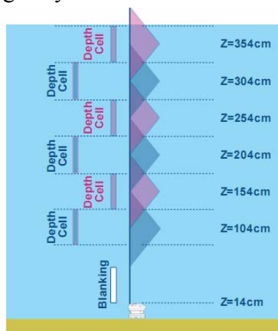
Hình: Sơ đồ phân bố các Cell dòng chảy với kích thước 1 cell = 0.5m
